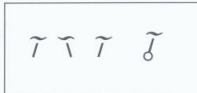
Pfähle, Rohre unter Wasser Piles, submerged pipes
